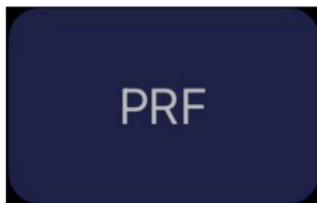
Die Impulse oder Pulsrepetitionsfrequenz (PRF) ist ein Parameter, der vom Bediener eingestellt wird. Sie definiert die Rate oder Frequenz, mit der der Schallkopf Ultraschallimpulse aussendet, um die Probe darzustellen. Dies hängt mit der zu untersuchenden Flussgeschwindigkeit zusammen. Das bedeutet, wenn die Flussgeschwindigkeit hoch ist, erfordert dies eine hohe Abtastrate, um zuverlässige Daten zu erhalten, daher muss die PRF hoch sein.
