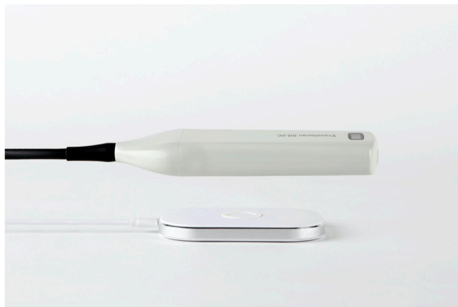
Die Akkulaufzeit beträgt 6 Stunden bei kontinuierlichem Betrieb und 14 Stunden im Standby-Modus. Daher empfehlen wir dringend, das Bild einzufrieren, um den Akku zu schonen, wenn Sie zwischen einem Tier und dem anderen nicht untersuchen. Dies ist besonders ratsam, wenn Sie den ganzen Tag über viele Stunden arbeiten müssen.
