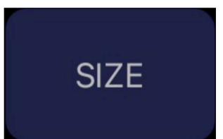
Wenn die Schaltfläche SIZE aktiviert ist, können Sie die Größe des Untersuchungsbereichs anpassen. Es ist ratsam, dass die Größe des "Kastens" möglichst klein ist, insbesondere in Bezug auf die Breite, und dass er so oberflächlich wie möglich ist, da dies eine höhere Anzahl von Einzelbildern pro Sekunde bedeutet und das Bild schneller gebildet wird.
